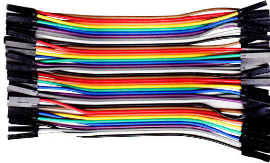
Figura 5.2: Cables para conectar los módulos.
