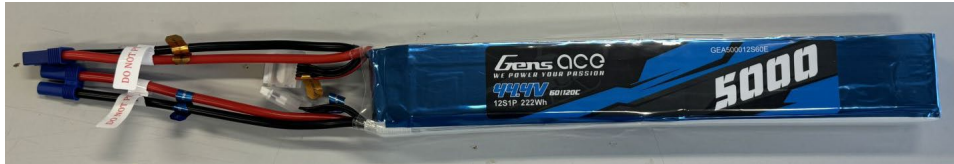
Figura 3. Batería G-Tech 44.4 V 5500 mAh 12S1P.
