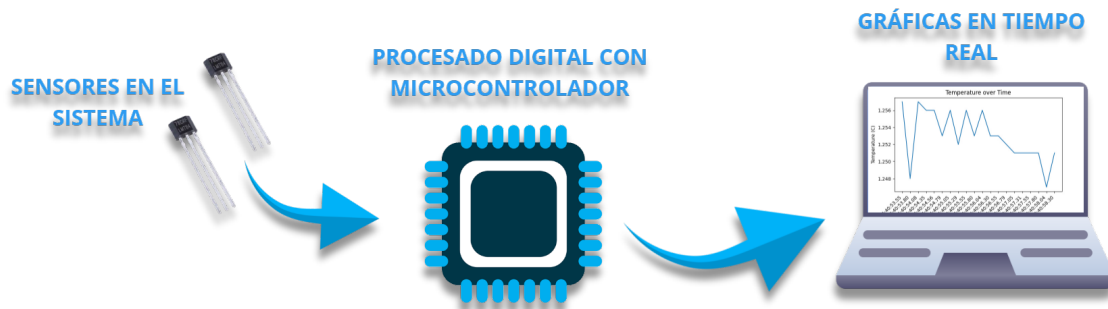
Figura 13. Esquema del graficado de los datos en tiempo real.
