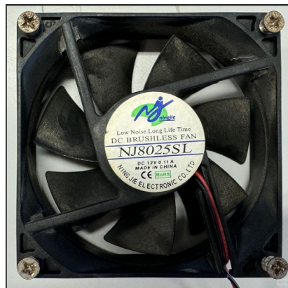
Figura 12. Ventilador de 12 V de la PEMFC.
