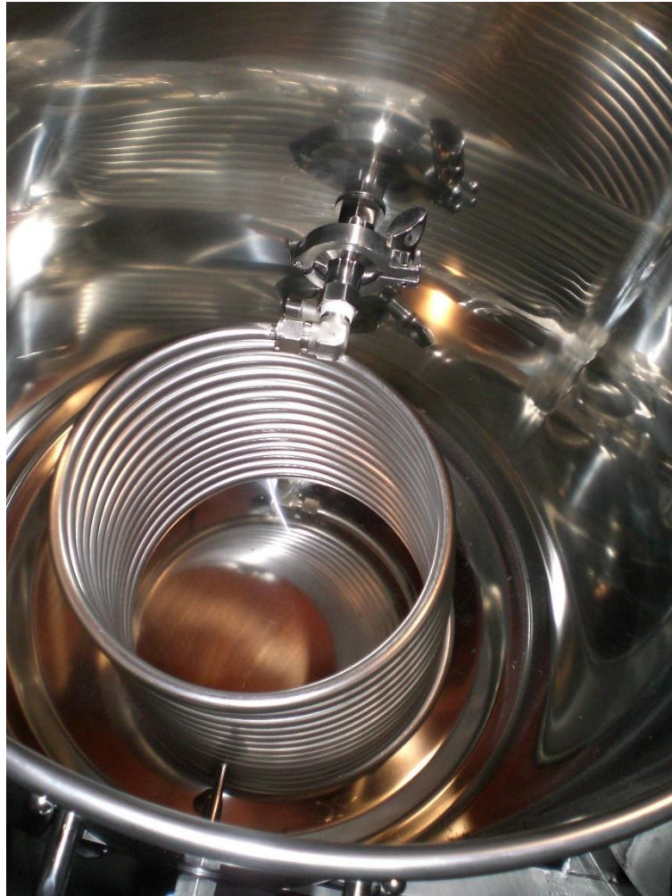
Figura 19-Serpentín dentro de olla
