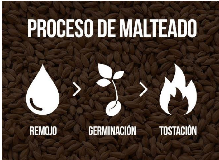
Figura 13-Infografía del proceso de malteado
