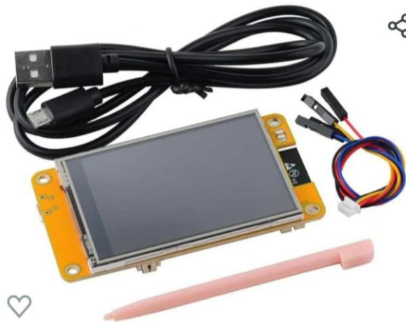
Figura 34- "Cheap Yellow Display", shield con un ESP32 y pantalla táctil
