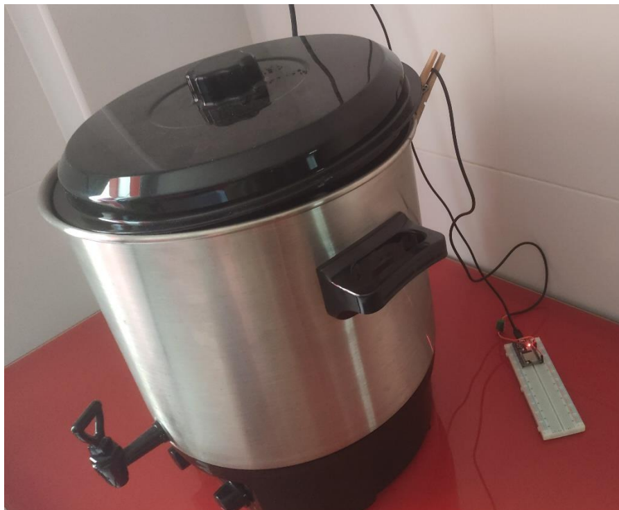
Figura 47-Montaje experimental toma de datos. La pinza es para que el cable del sensor no esté en contacto directo con la olla.
