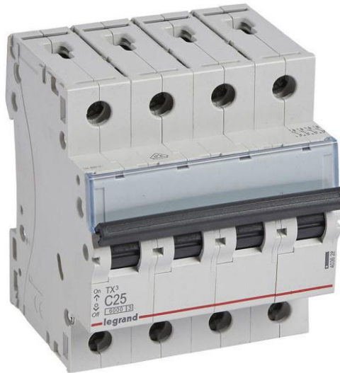
Figura 20. Magnetotérmico 25 A 4P 6 kA C de Legrand.
