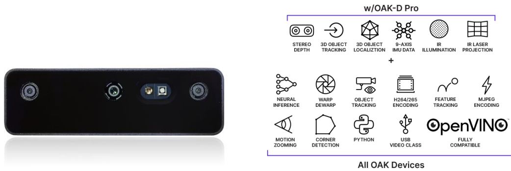
Figura 19 - Cámara OAK-D-Pro y sus funcionalidades
