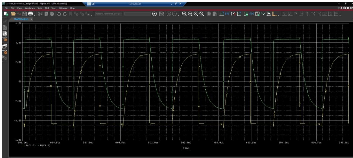
Fig. 21 (Formas de onda de la carga de los condensadores, sensor min. 10pF)
