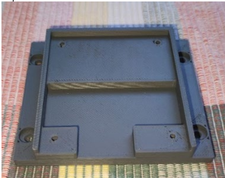
Imagen 4. Pieza "Base del U2D2 Power hub"
