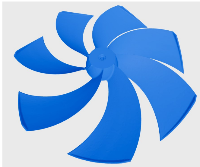
Figura 3: Model 3D de les aspes del prototip.
