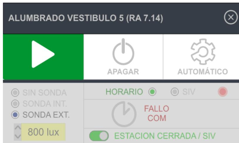
Figura 31 - Imagen Alumbrado Manual Encendido Fuente: Elaboración Propia
