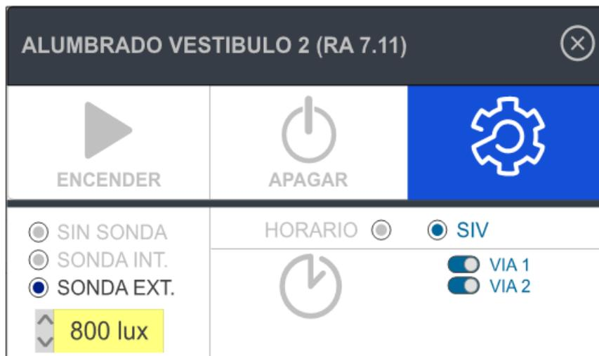
Figura 40 - Imagen SIV con SONDA EXTERIOR Fuente: Elaboración Propia
