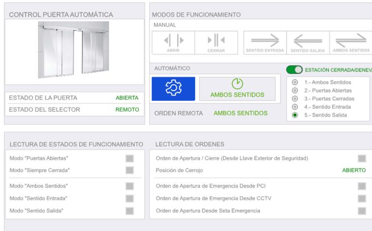
Figura 80 - Imagen Modo Automático 2 Fuente: Elaboración Propia
