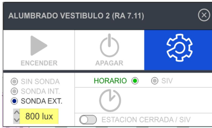
Figura 39 - Imagen Horario con SONDA EXTERIOR Fuente: Elaboración Propia
