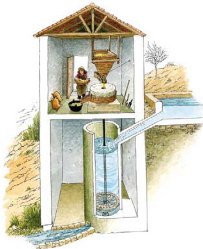
Ilustración 2.5. Grabado de Molino de regolfo. 14
