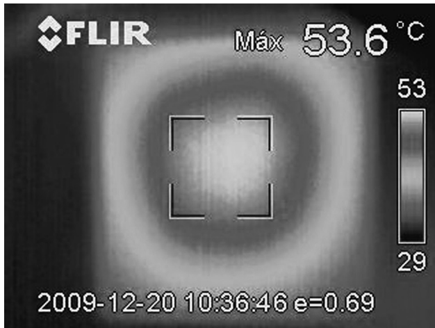
Figura 7. Termografía de la muestra de ensayo 1 después de la radiación, donde se observa el calentamiento que se produce desde el reverso de la muestra, es decir desde la cara irradiada
