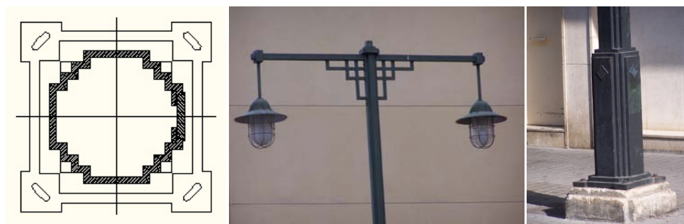
Fig. 570, 571 y 572 Sección horizontal de la parte baja del báculo, brazos y arranque de la farola tipo Alcoy. (IGS y JFPS 2010)
