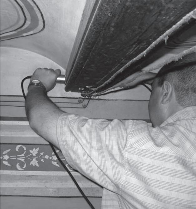
Figura 16 Auscultación mediante ultrasonidos en una de las viguetas
