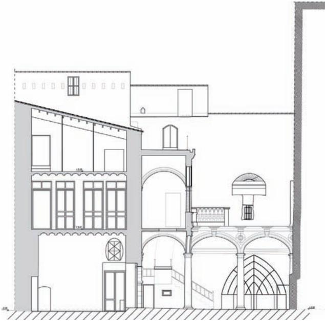
Figura 11.w Sección transversal del palacio, con la medianera de las viviendas dividiendo el claustro
