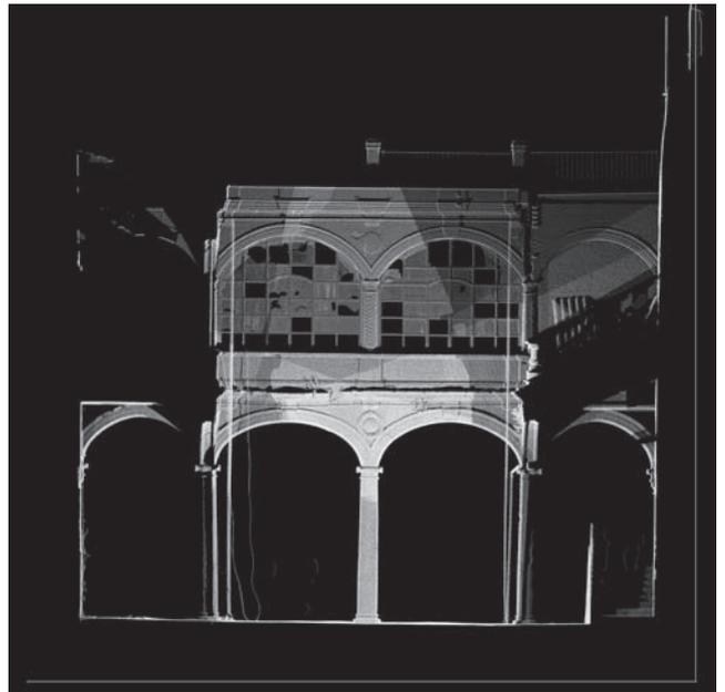
Figura 14 Sección por el patio renacentista. Nube de puntos realizado por el escáner-láser 3D
