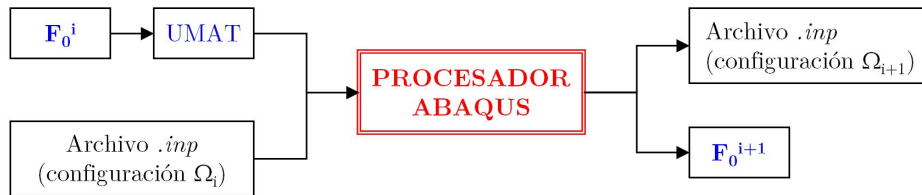
Figura 8.14: Compilación de la subrutina UMAT entre dos configuraciones i e i + 1 .
