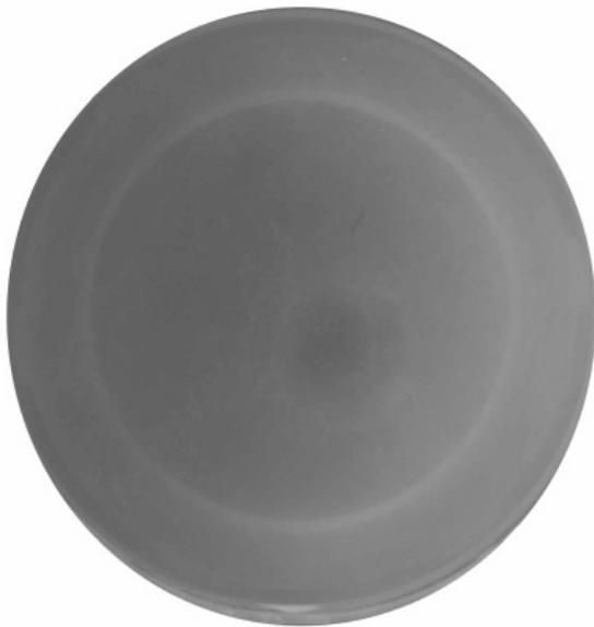
Figura 5 Espécimen IIA (2g gelatina técnica en 20ml H<sub>2</sub>O + 1ml Esencia de Alcanfor 288H)
