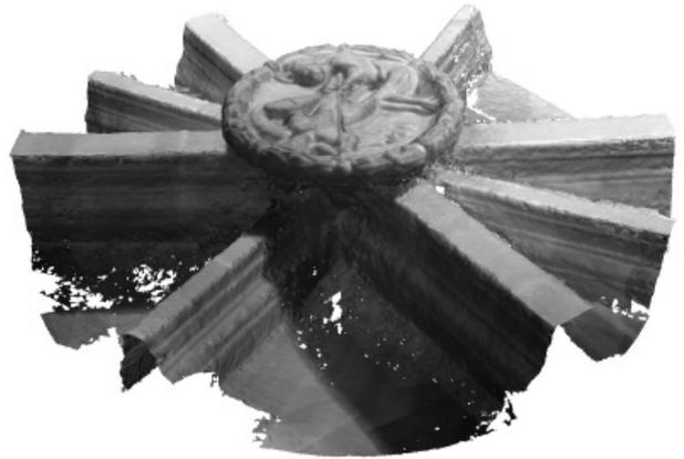
Figura 8. Restitución fotogramétrica de la clave polar de la bóveda del coro de la iglesia de Villafranca del Cid
