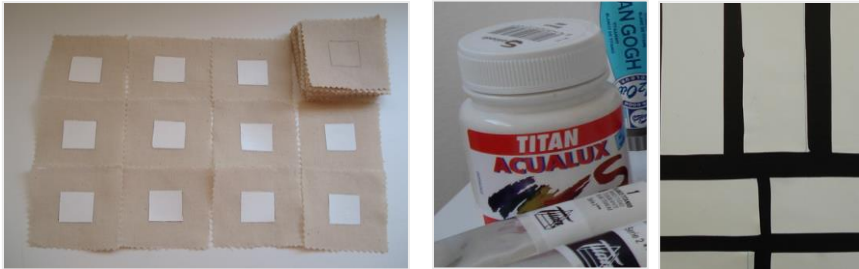
Fig. 376. Muestras pintadas Grupo 0 y soporte textil muestras Grupo A y B. Fig. 377. Pintura Acualux® Titan. Película pictórica vinílica seca y suelta muestras Grupo A y B.
