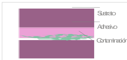
Fig. 157. Esquema de rotura de capas débiles debido a la presencia de contaminación.
