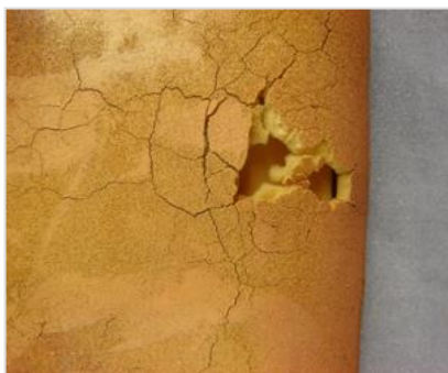
Fig. 54. Degradación de espuma de poliuretano. A. Cillero, La Galleta , 1970. MACV.
