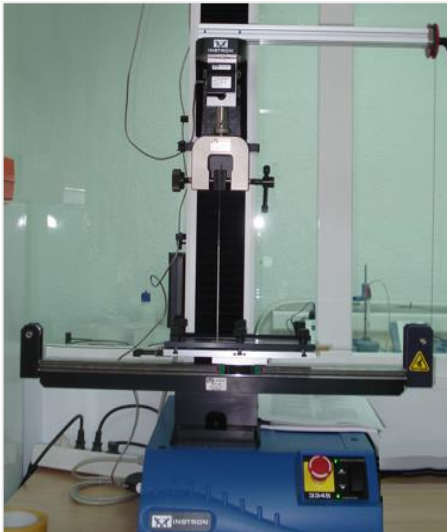
Fig. 423. Muestras y montaje en Rampa de pelado 90°.
