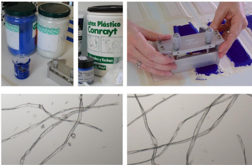
Fig. 409 y 410. Elaboración de muestras y aplicador de capa. Fig. 411 y 412. Algodón. 10X. Identificación de las fibras de la retorta fina y loneta empleadas en las probetas.
