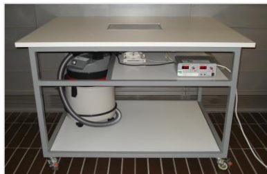
Fig. 262. Mini mesa de succión, IVC+R.
