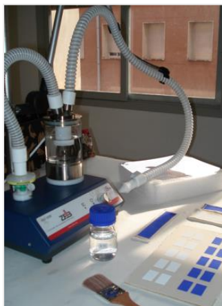
Fig. 417. Aplicación de los consolidantes con nebulizador por ultrasonidos ZFB®. Fig. 418. Muestras de prueba: aplicación gota de consolidante y secado.
