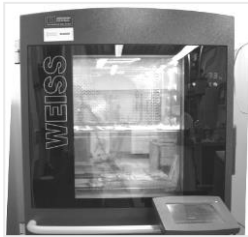
Fig. 382. Cámara climática Weiss WK3 180/40. ITC-UJI.
