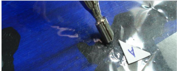
Fig. 200 y 201. Aplicación adhesivo y corrección de la deformación.
