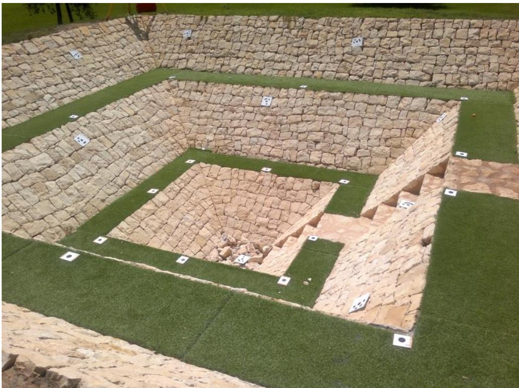
Figura 4.4 Campo de calibración: pirámide invertida sita en el Campus de Vera
