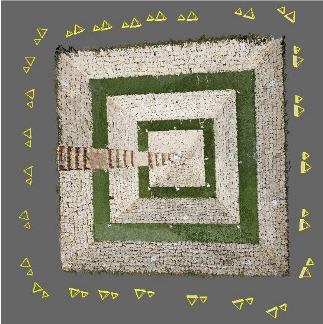
Figura 5.29 Nube de puntos 3D y configuración espacial de la toma. Vista en planta
