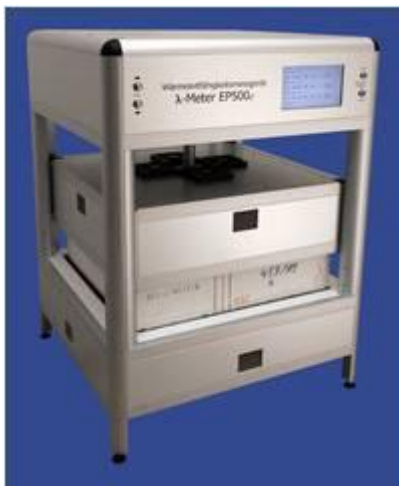
Figura 4.32. Equipo para el ensayo de resistencia térmica
