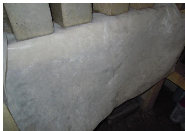
Figura 5.13. Protección de probetas con bolsa de polietileno en cámara húmeda
