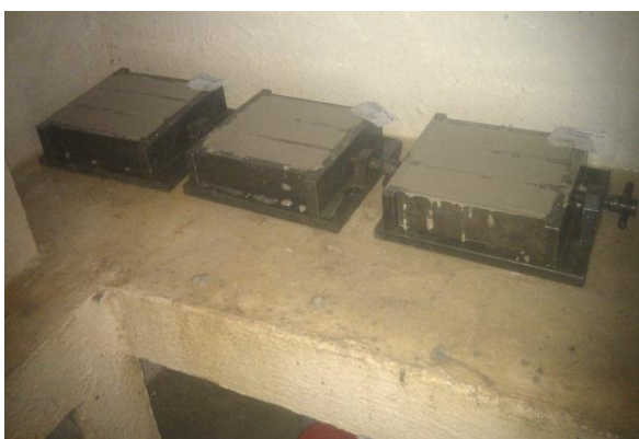
Figura 5.9. Moldes en cámara húmeda
