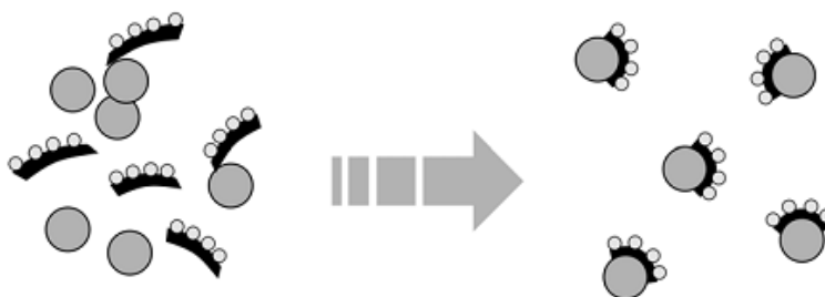
Figura 3.18. Acción de los aditivos plastificantes provocando el proceso de repulsión entre partículas
