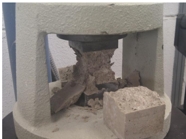
Figura 5.45. Probeta rota a compresión
