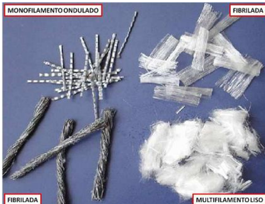
Figura 3.20. Tipos de fibras de polipropileno: monofilamento, multifilamento y fibrilada [THE ABERDEEN GROUP 1983; ACI Committee 544 2002]
