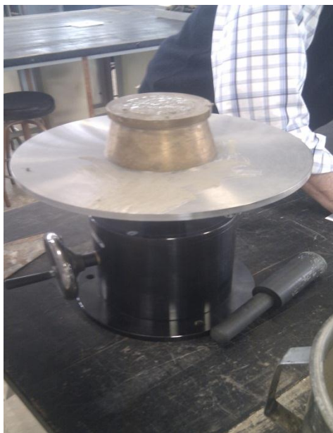
Figura 5.24. Limpiar plato después de verter el mortero
