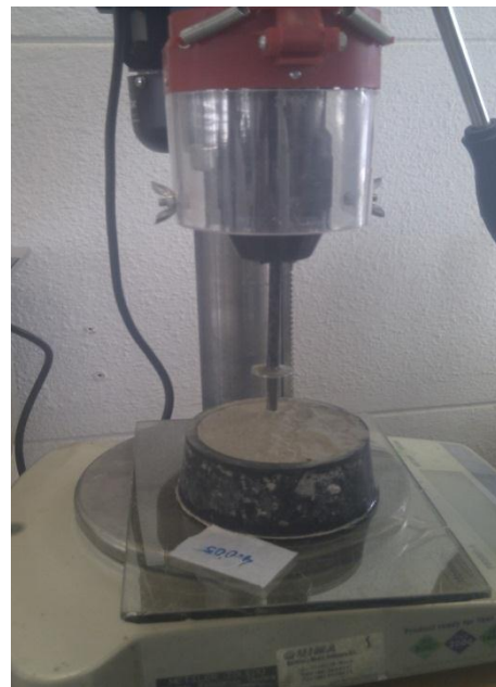
Figura 5.31. Colocación del molde
