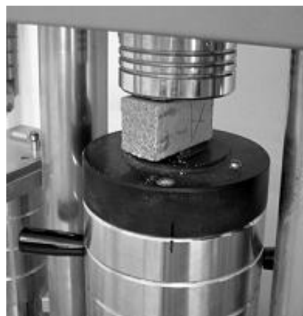
Figura 3.4. Ensayos de compresión
