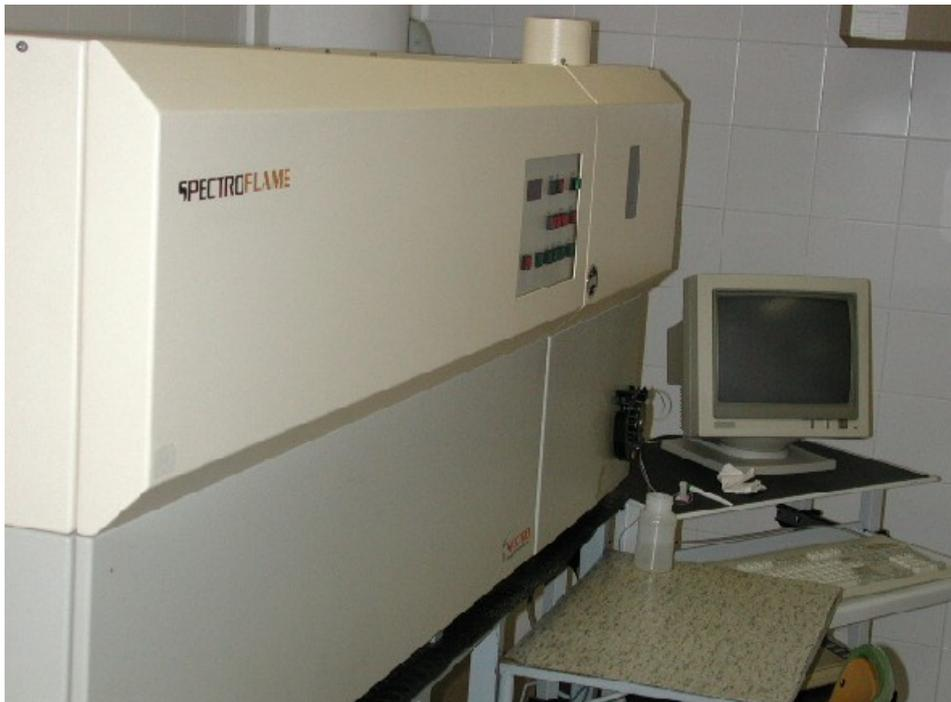
**Figura 15:** ICP para la medición de metales pesados en las muestras de agua.
