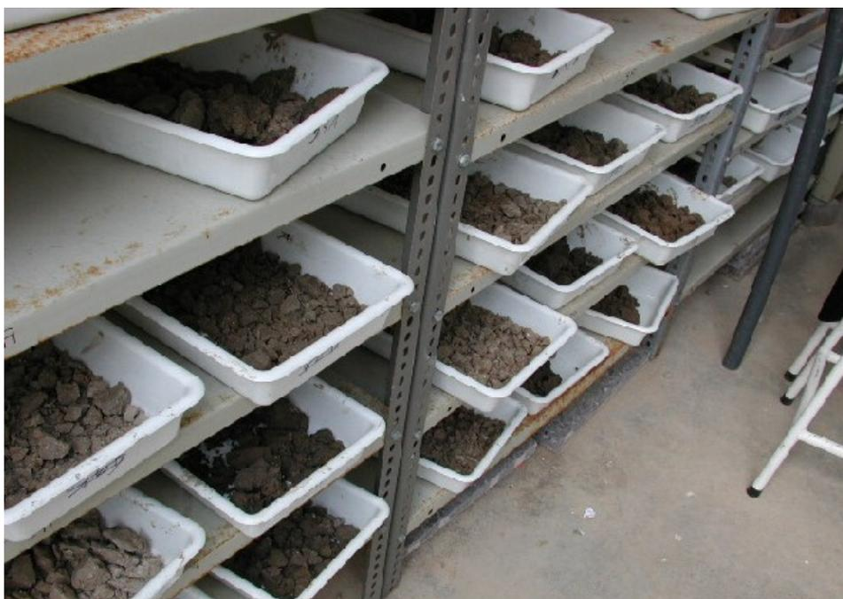
**Figura 7:** Secado de muestras de suelo en bandejas.
