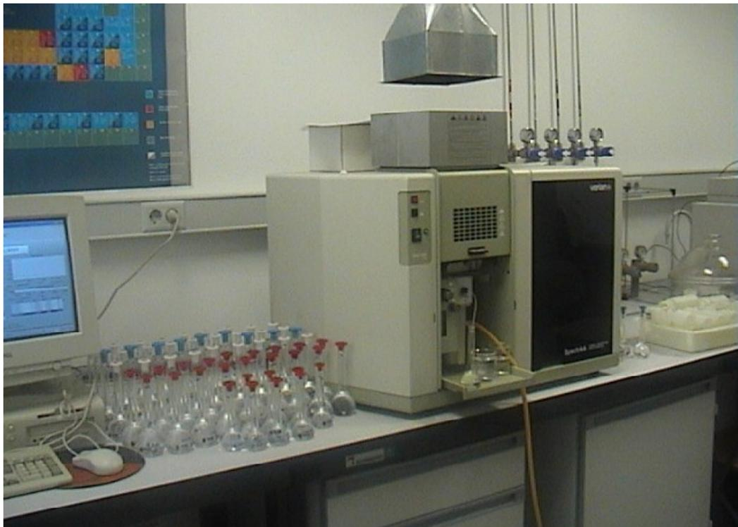
**Figura 14:** Espectrofotómetro de absorción atómica.
