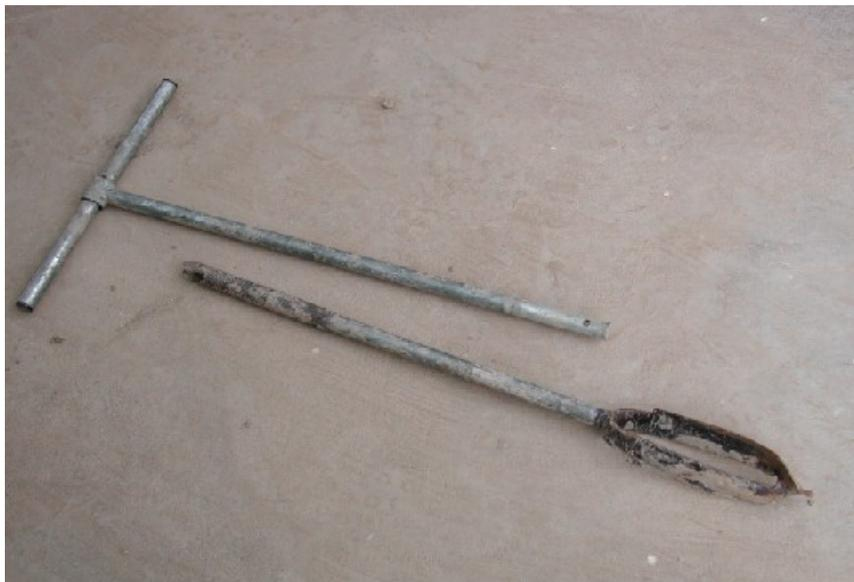
**Figura 5:** Barrena para la extracción de muestras de suelos.
