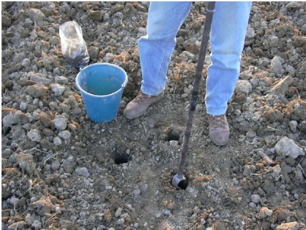
**Figura 6:** Extracción de muestras de suelo.
