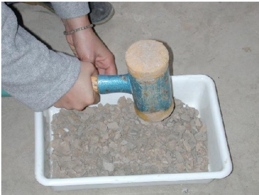
**Figura 8:** Molienda de las muestras de suelo con mazo.
