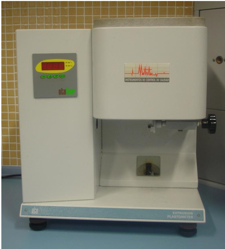
Figura I. 1-27. Plastómetro del laboratorio de materiales
