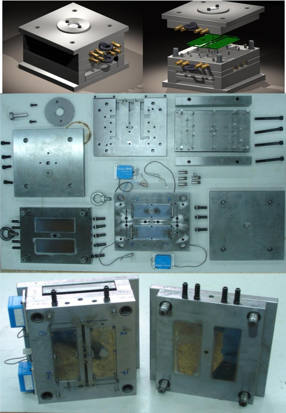
Figura I. 1-22. Molde con sensores de presión y temperatura
