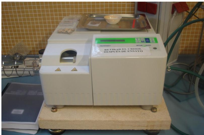
Figura I. 1-30. Esquema y foto de la termobalanza TGA/SDTA 851.
