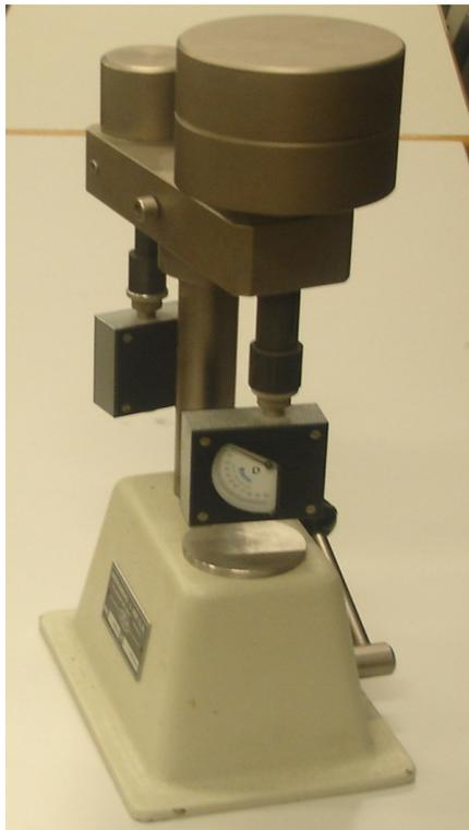
Figura I. 1-25. Durómetro del laboratorio de materiales
