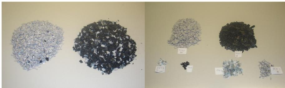
**Figura I. 1-1. Fotografía de las dos muestras de ABS triturado.**
