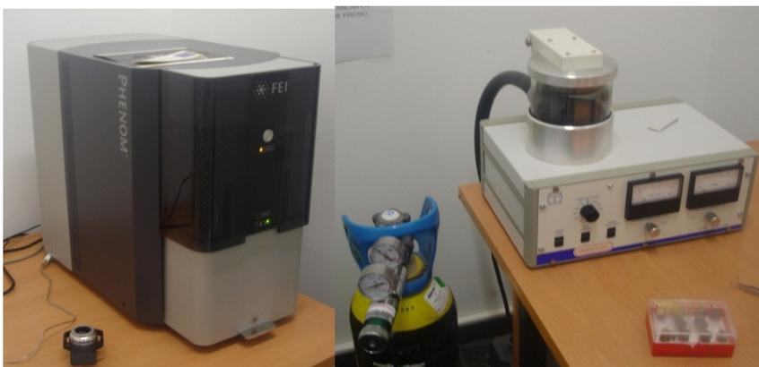
Figura I. 1-31. SEM y metalizador del laboratorio de materiales
