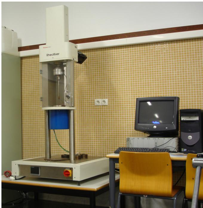
Figura I. 1-26. Esquema del reómetro capilar y reómetro del laboratorio de procesos
