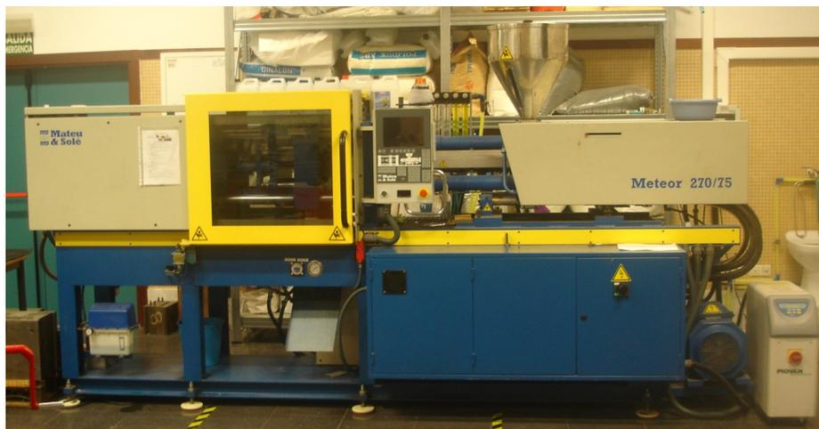
**Figura I. 1-19. Inyectora del laboratorio de procesos de fabricación**
