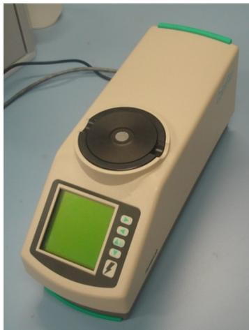
**Figura I. 1-34 Colorímetro del laboratorio de materiales**
