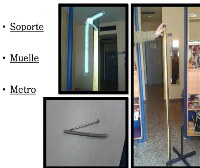
*Figura 3. Soporte para el estudio de la relación  $f(m)$  en un oscilador lineal*
