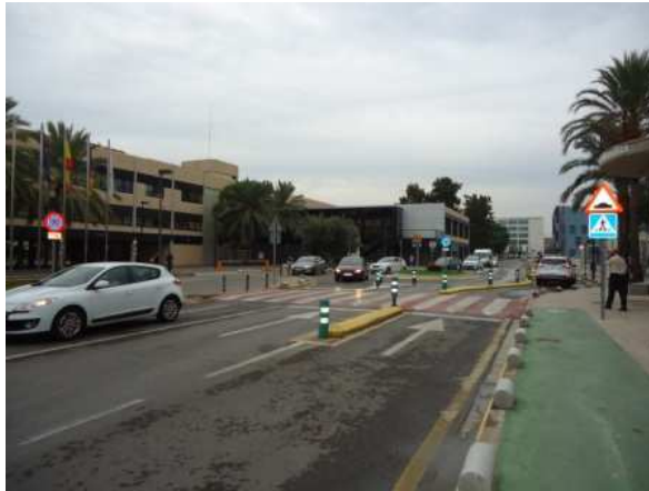
Señalización y delimitación de los carriles de circulación y sentidos. Presencia de bolardos para impedir que los vehículos a motor invadan el itinerario peatonal / ciclista
