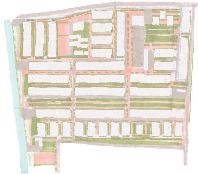
Utilizar cambios de rugosidad en el pavimento como elemento diferenciador para marcar las zonas en que se permite el uso esporádico del coche. Donde haya tráfico rodado, el pavimento se endurece pero se sigue dando paso a la vegetación.
