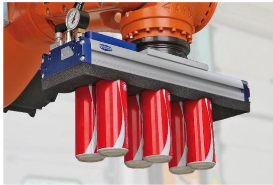
Figura 2.2. Gripper FXP de la empresa Schmalz
