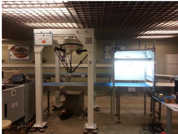
**Figura 3.15.** Robot delta IRB 360 de ABB, controlador y sistema de visión del laboratorio L.A.S.A del AI2.
