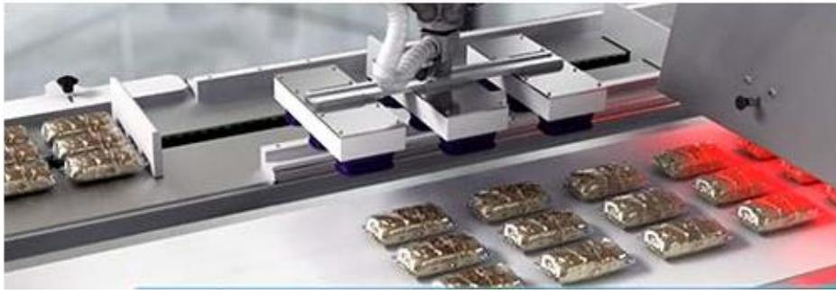
**Figura 3.2.** Ejemplo de operación pick and place con pinza multi-pick fija.
