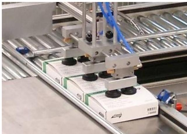
**Figura 2.4.** *Palletiser for small boxes* de la empresa Roteg
