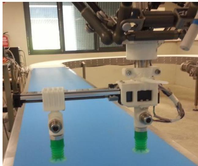
Figura 5.5. Montaje real de la herramienta multi-pick doble acoplada sobre el robot delta IRB360 ABB.
