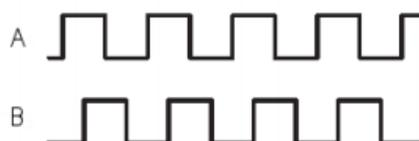
Figura 4.7. Señales de pulso generadas por encoder incremental.
