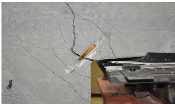
DET. DE LA ESQUINA EN LA CARA DORSAL TRAS LA ROTURA
