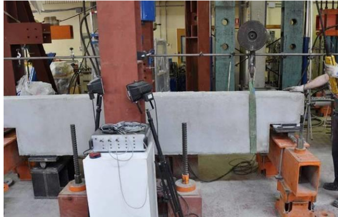
Fotografía III.5: Montaje de probeta en pórtico de ensayo
