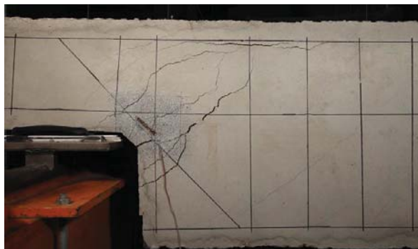
VISTA GENERAL DEL APOYO A LA CARGA MÁXIMA
