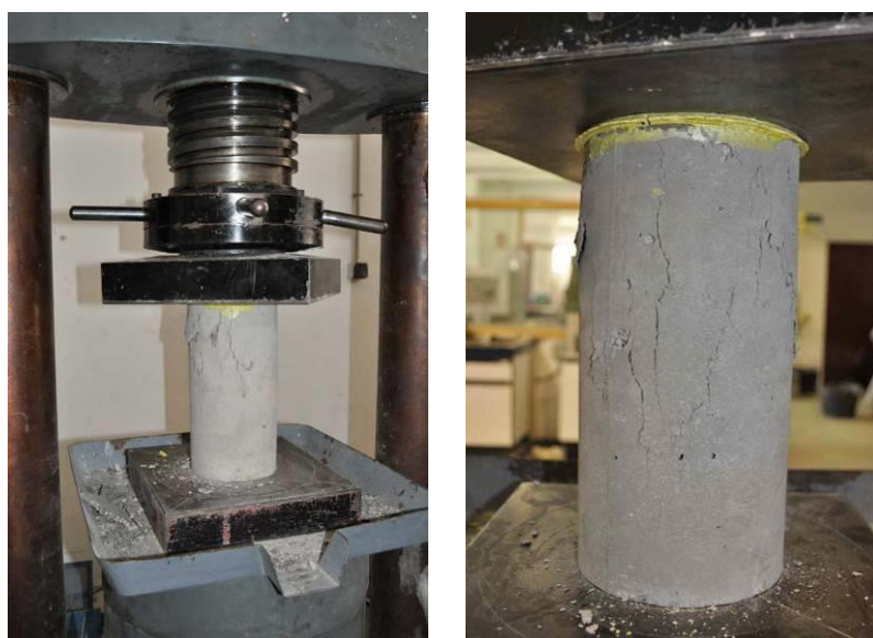
Fotografía C.1: Ensayo de compresión simple del hormigón: (a) Vista general de ensayo; (b) Detalle de probeta tras rotura
