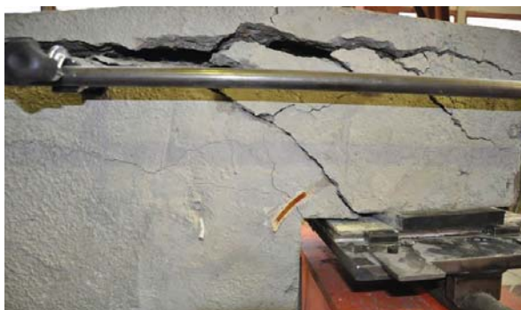
VISTA DEL LADO DORSAL TRAS LA ROTURA
