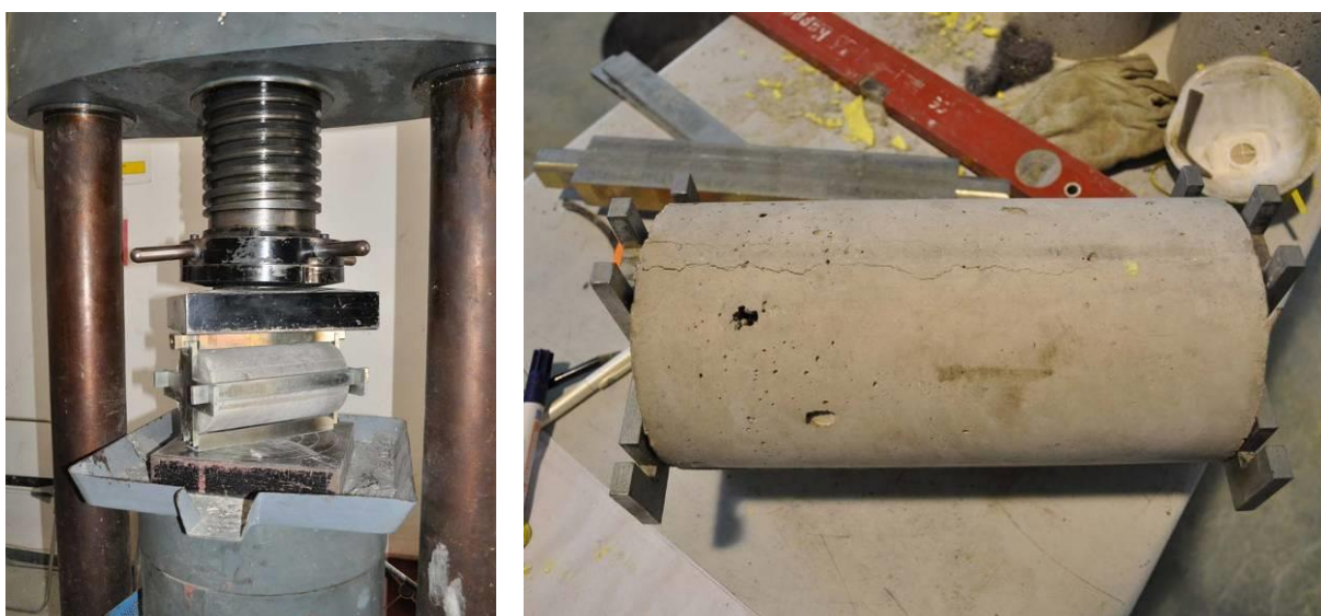
Fotografía C.2: Ensayo de tracción indirecta del hormigón: (a) Vista general de ensayo; (b) Detalle de probeta tras rotura
