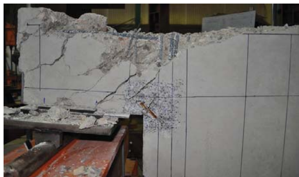
VISTA GENERAL DE LA PIEZA TRAS LA ROTURA
