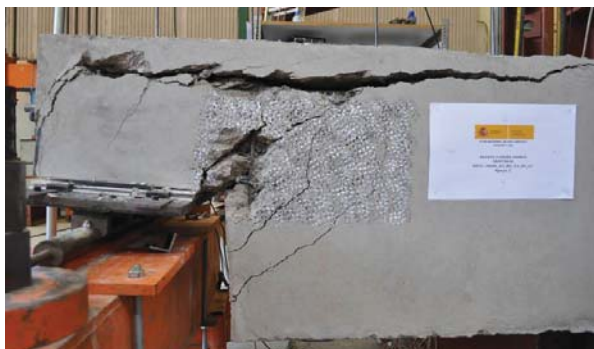
VISTA GENERAL DEL APOYO TRAS LA ROTURA
