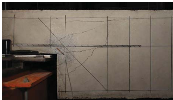
VISTA GENERAL DE LA PIEZA A LA CARGA MÁXIMA
