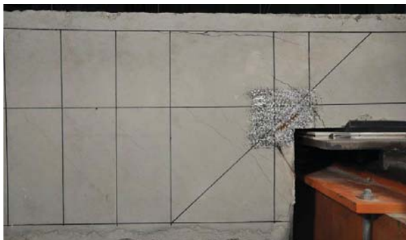
VISTA APOYO. CARGA MÁXIMA
