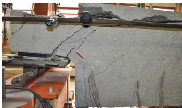
LADO DORSAL DE LA PIEZA TRAS LA ROTURA
