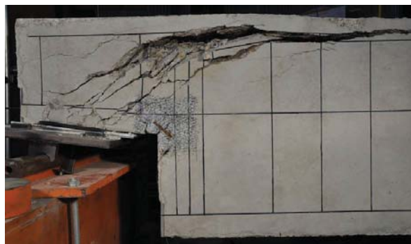
APOYO. ZONA POST-PICO (50% Vmax). INSTANTE PREVIO A COLAPSO
