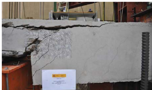
VISTA GENERAL DE LA PIEZA TRAS LA ROTURA. FISURAS FLEXIÓN
