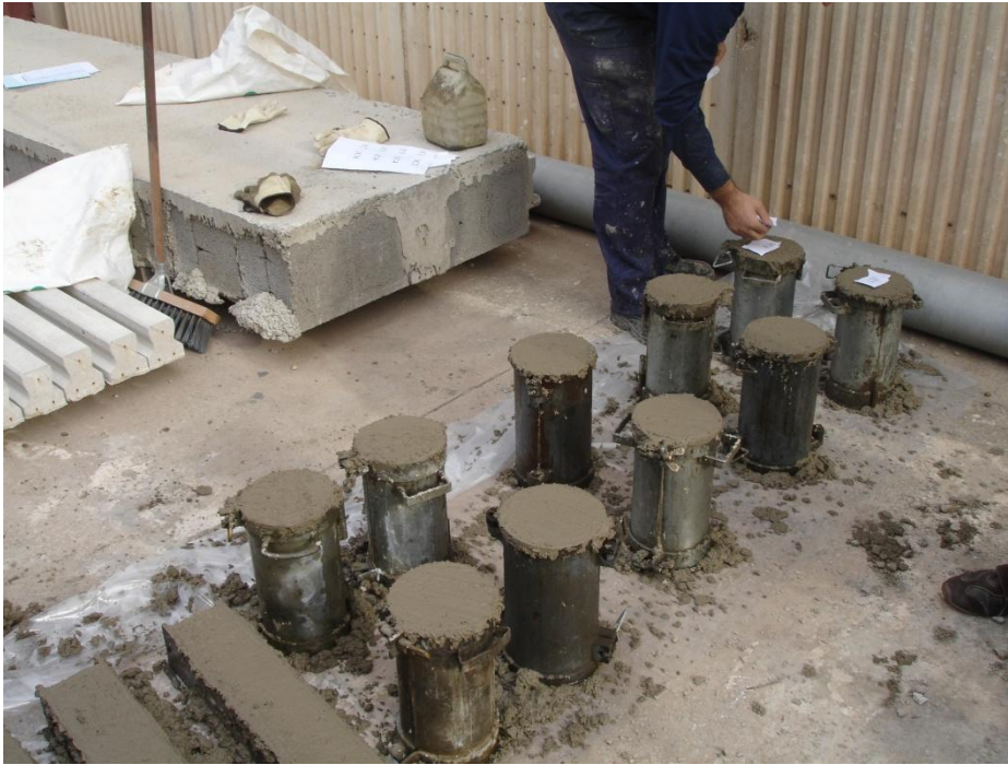
Fig. II.10 Probetas de hormigón curadas en las mismas condiciones que el forjado 1
