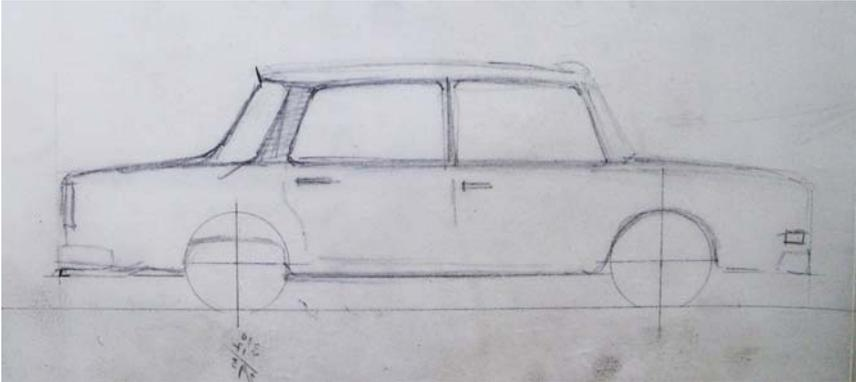
Dibujo de Mauro Lleó de una S.E.A.T. 1400 para estudio del radio de giro de las rampas del edificio B (depósito de automóviles) de la filial de Valencia.
