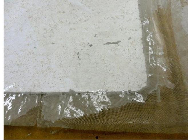
6. Detalle de la probeta una vez seco el adhesivo.
