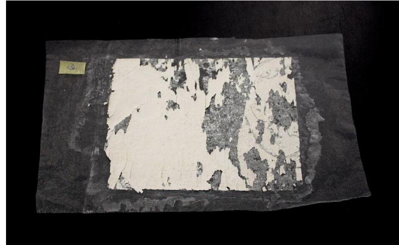
2. Resultado de la probeta tras haber adherido el tejido con Reglarez® por el reverso y eliminado cola y tela de arranque.
