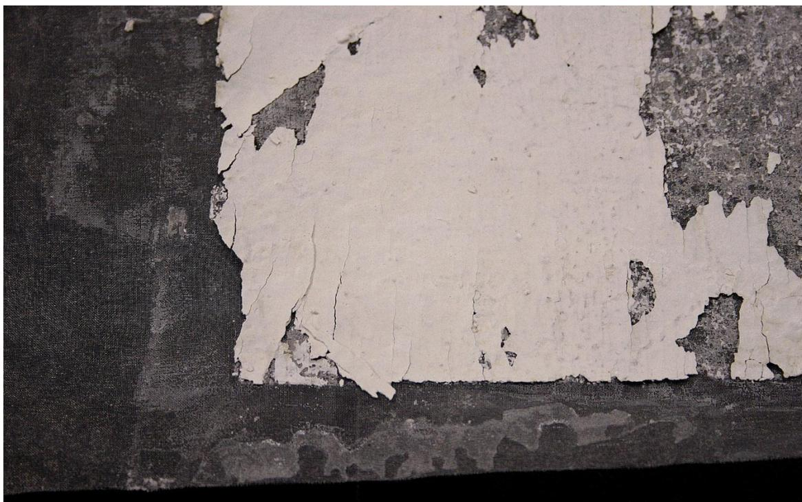
Fig.18 Detalle del fallo adhesivo en la probeta realizada con Regalrez®. Elaboración propia.
