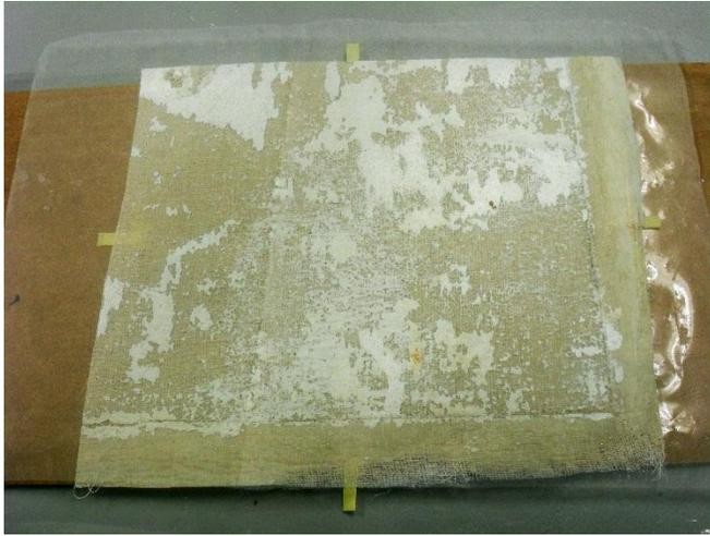
1. Probeta (específica de esta experimentación) sin cemento y con la tela dispuesta sobre ella.
