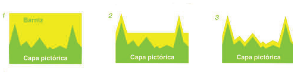
Imatge 1 Reinterpretada de Nicolaus Knut (1999: 327). 1: Capa de vernís acabat d'aplicar. 2: Capa de vernís de baixa viscositat després de l'asseccament. 3: Capa de vernís d'alta viscositat després de l'asseccament.
