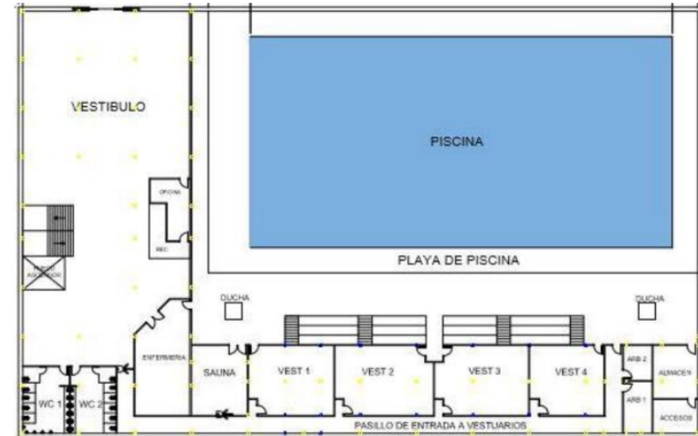
Imagen 6. Vista de planta de planta baja de una primera alternativa de distribución. Fuente: Propia
