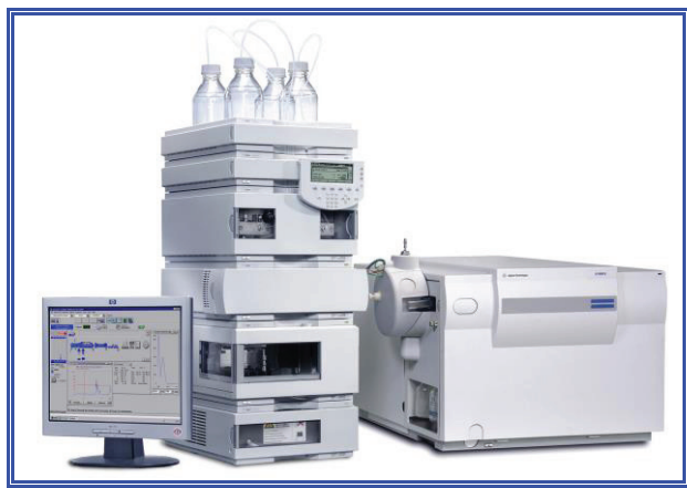
Figura 113. Sistema de HPLC acoplado con un detector de espectrometría de masas (imagen cortesía de Agilent Technologies ).
