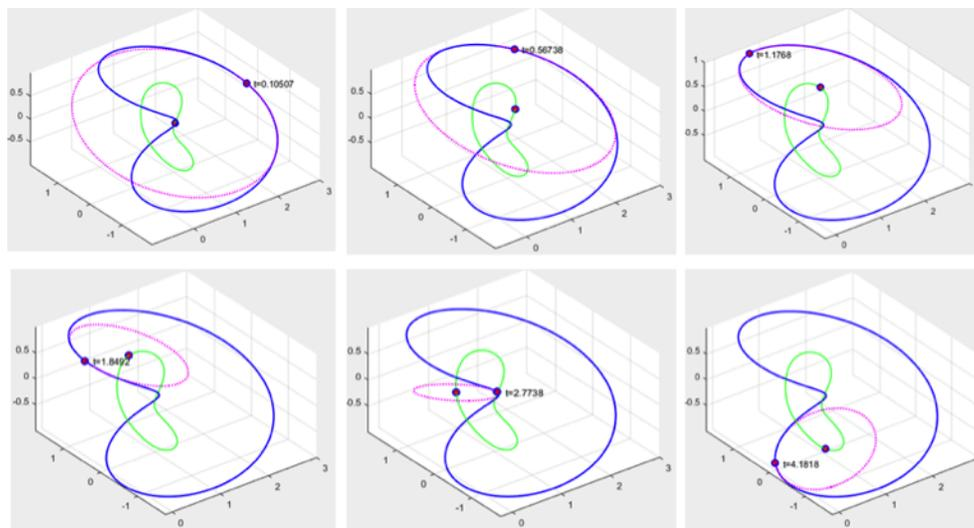
Figura 6 – Gráfica de la curva del ejemplo, de su círculo osculador y de su evoluta.
