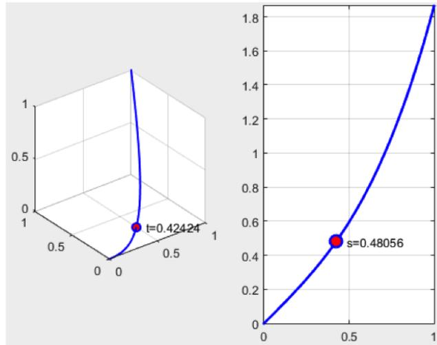
Figura 3 – Gráfica de la curva del ejemplo y su longitud de arco.
