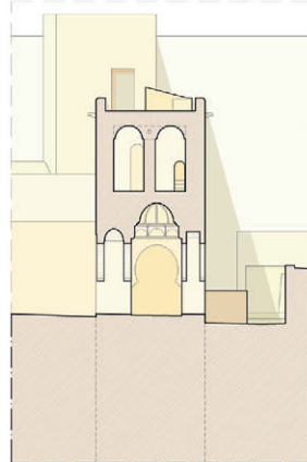
TORRE DE LAS ARMAS - SECCIÓN ST4-ST4'
