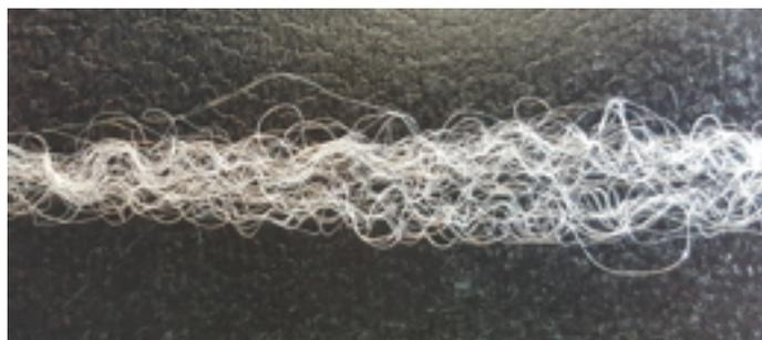
Figura 1: Ejemplo de fibras con efecto auto-rizado.
