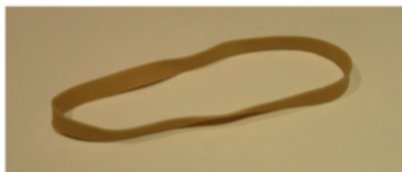
Figura: Fotografía de la goma para evaluar su módulo de elasticidad.
