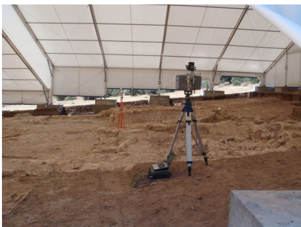
Figura 6: Toma de datos del mosaico mediante láser escáner.
