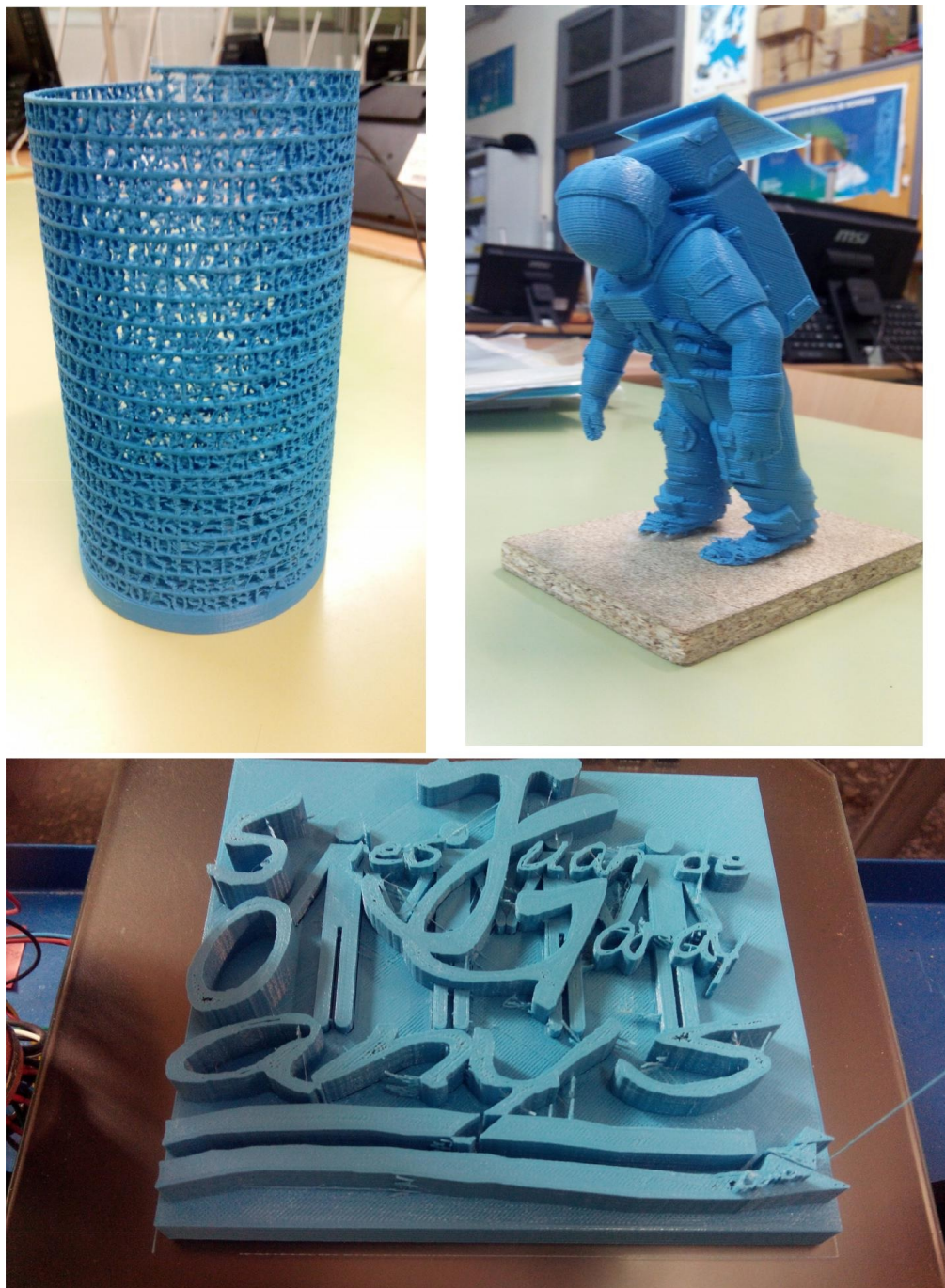
Figura 1: Algunos ejemplos de las piezas impresas con la Prusai3 montada por los alumnos.
