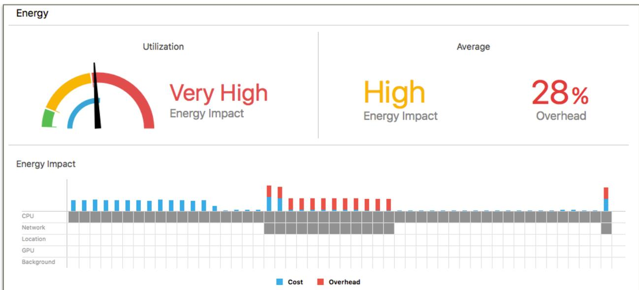
Figura 31: Visualización de la monitorización del consumo energético con Xcode
