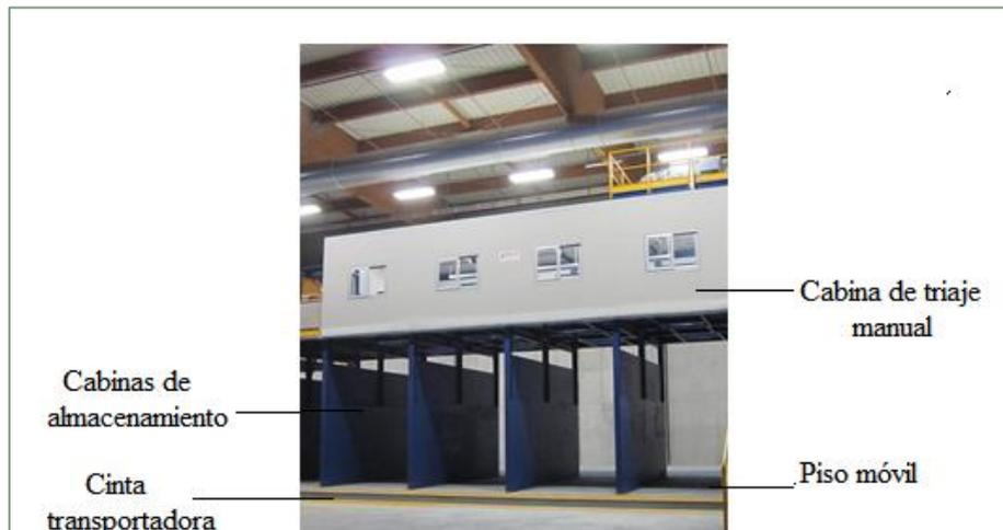
Figura N° 16 Cabinas de almacenamiento con piso móvil.
