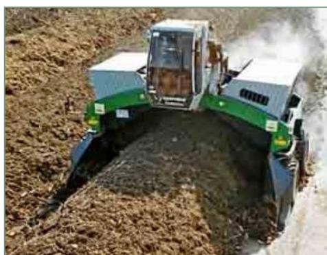
Figura N° 23 Maquinaria de volteo y riego.
