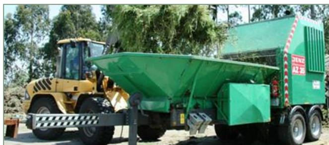
Figura N° 22 Trituradora móvil de residuos a compostar.
