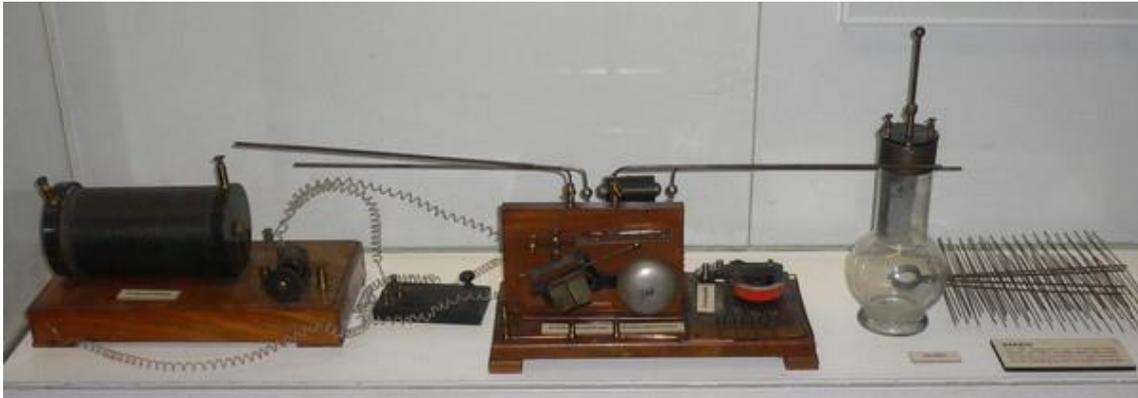
*Figura 1. Antena, medio receptor y transmisor del Telemobiloscopio.*
