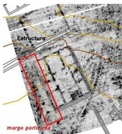
**Figura 12:** Planta geofísica con indicación de anomalías en la fachada delantera, interpretada como los pilares de la *margo*.
