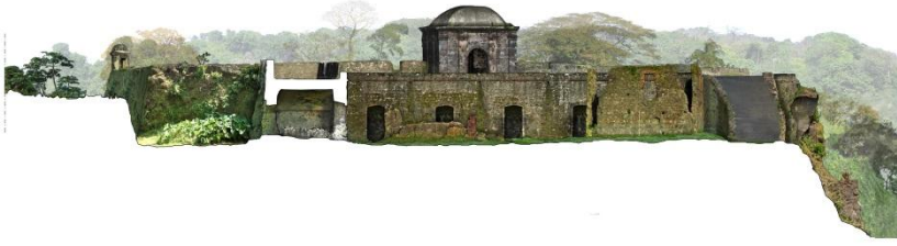
Fig. 8- Sezioni ambientali del forte e del suo contesto. L'elaborazione delle sezioni è stata impostata sulla base del modello fotografico tridimensionale, ricomponendo le singole porzioni in cui il modello era stato scomposto in fase di acquisizione.
