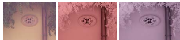
Figura 6: Toma fotográfica en el espectro visible (izquierda), utilizando un filtro IR de paso bajo (centro) y utilizando un filtro de paso alto (derecha).
