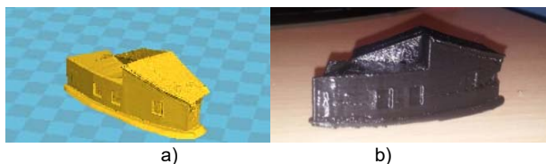
Figura 11: Impresión 3D: a) Generación del objeto 3D mediante CURA; b) Muestra de impresión.
